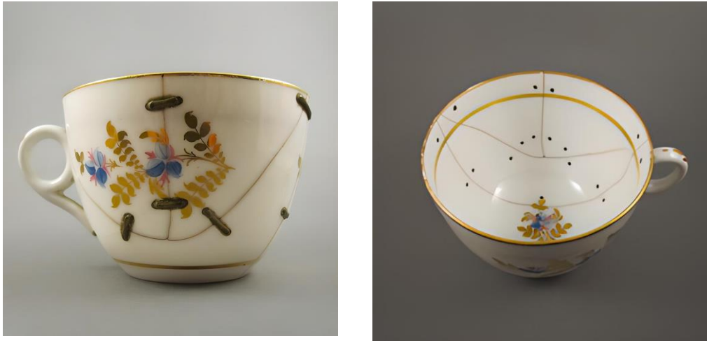
Görsel 4. Metal perçin ile tamir edilen seramik fincan 1810 (The New York Ceramics & Glass Fair, 2017)
